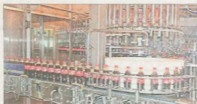
Mit dieser PET-Abfüllmaschine können pro Stunde bis zu 42 000 Flaschen Cola oder andere Getränke abgefüllt werden.
